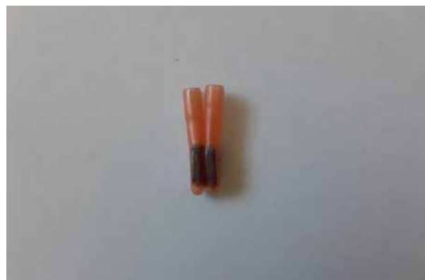
Рис. 2. Магнитные плашки в силиконовой оболочке.
