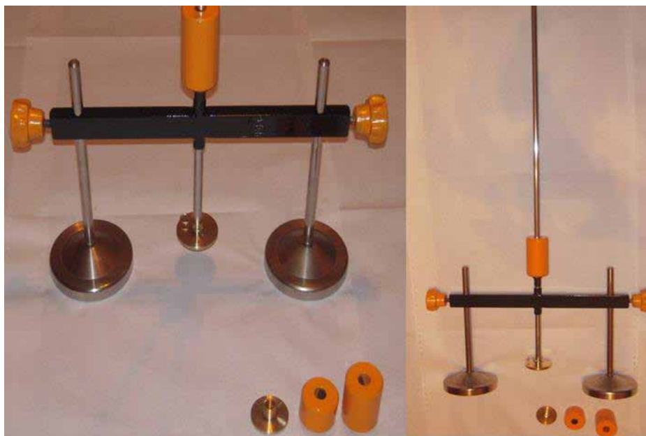
Рис. 2. Устройство для моделирования травмы печени у мелких лабораторных животных по механизму «удар».
